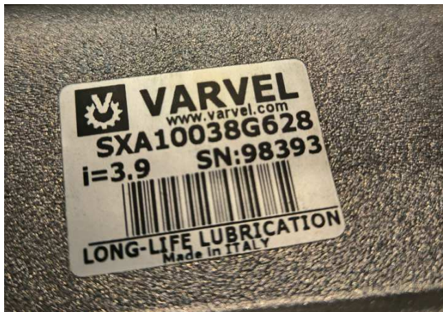
štítek předlohy u šnekové převodovky
