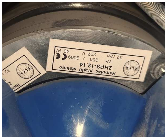
dvojitá brzda na hřídeli motoru
