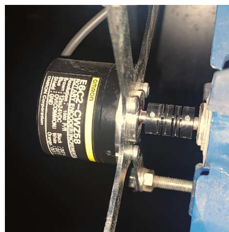
inkrementální čidlo na hřídeli motoru
